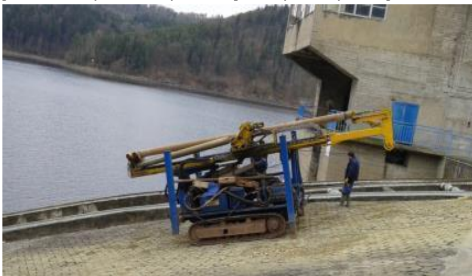
Obr. č. 3.1-1 Vrtná souprava RDBS pásák při sjíždění na pracovní plošinu vrtu VN-01
