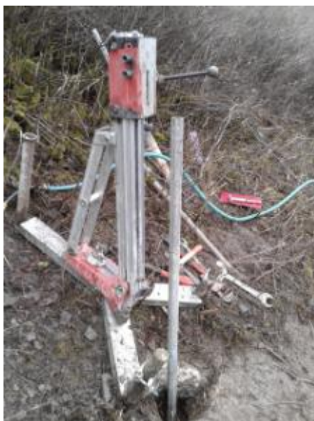
Obr. č. 3.1-2 Přenosná vrtná souprava HILTI DD500 (Vrt VN-07)
