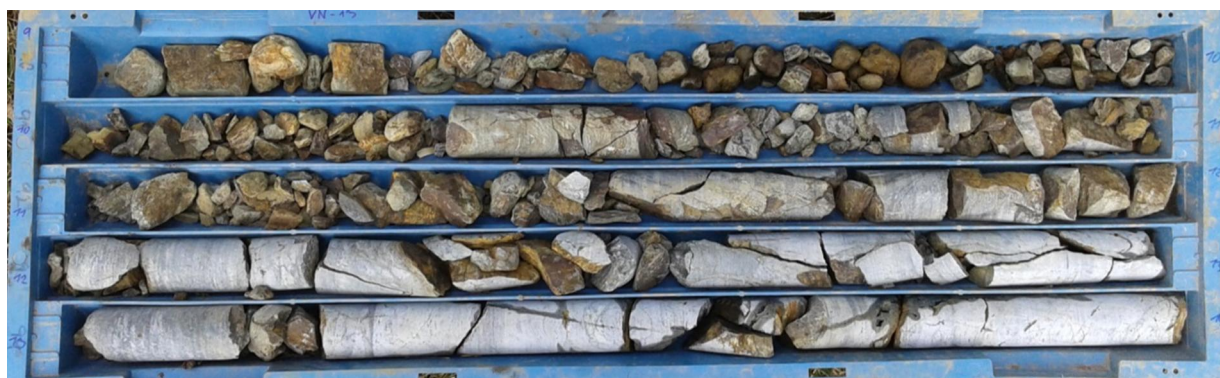
Obr. č. 4.1-1 Podélné tektonické poruchy a silné rozpukání i v hloubce 14 m
